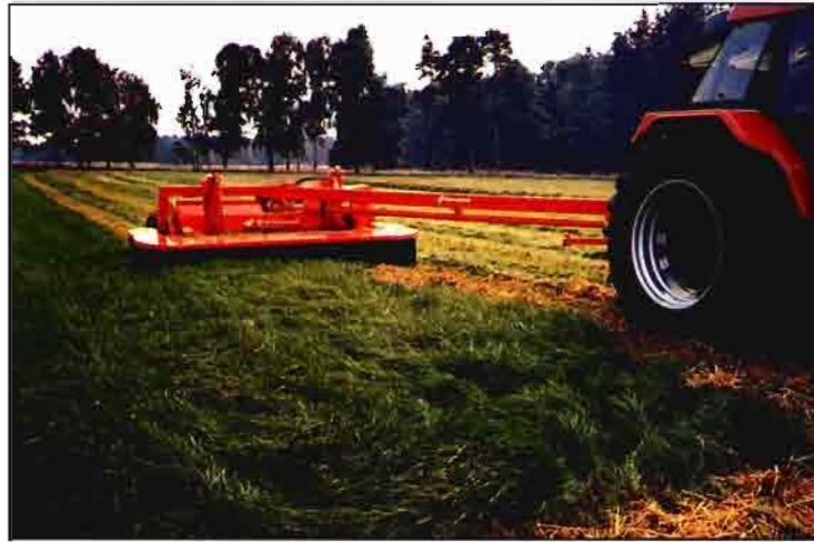
A la salida del acondicionador, los deflectores permiten dejar una hilera que facilitará la recogida.
