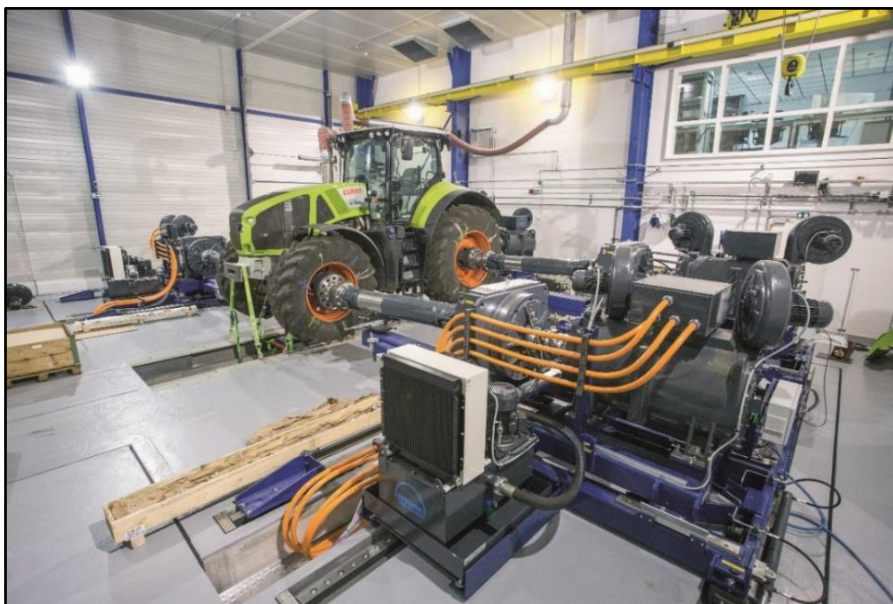
Figura 3.- Ensayo de la potencia en los ejes. CLAAS Testing and Validation Centre Trangé, Francia
