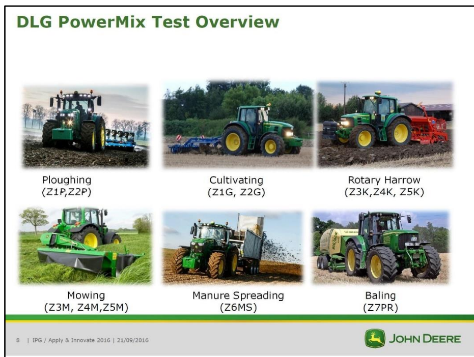
Figura 19.- Ensayos de campo para la toma de datos que sirvan para elaborar los ciclos PowerMix. Pieke, C. 2016
