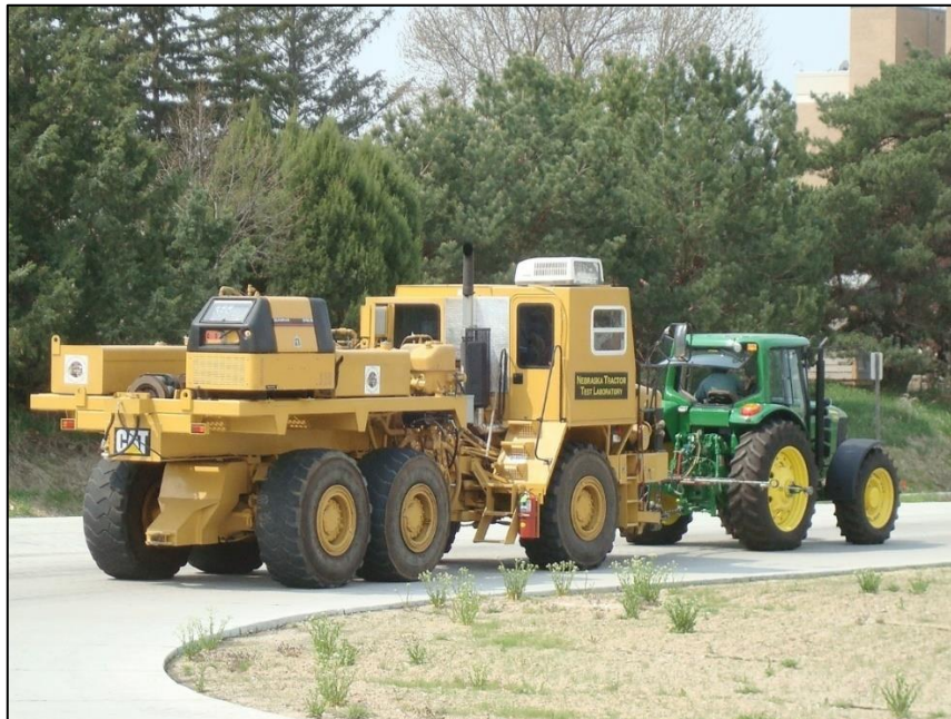
Figura 10.-Ensayo de potencia a la barra con carro dinamométrico en el National Tractor Test Laboratory de la Universidad de Nebraska-Lincoln (USA)
