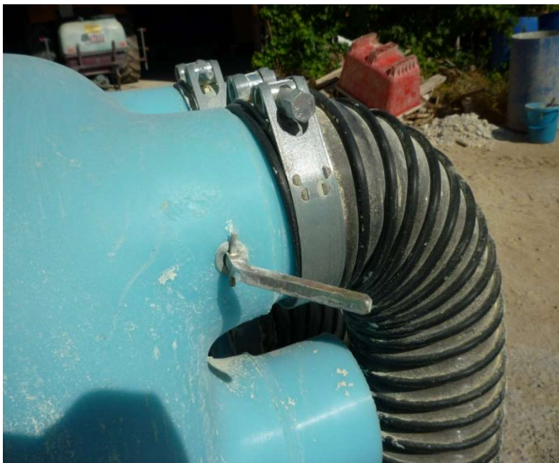
Foto 12. Los mandos de actuación de secciones están presentes y funcionan
