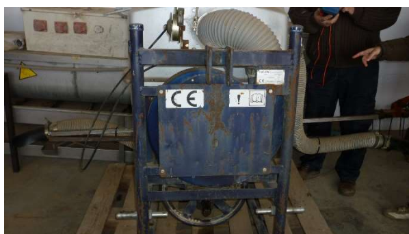
Foto 5. Espolvoreador con partes móviles sin resguardar
