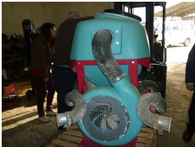
Foto 7. El sistema de aire no ha presentado problemas estructurales o de funcionamiento
