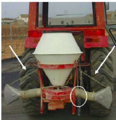
Foto 9. Existe un elemento que conecta a tierra
