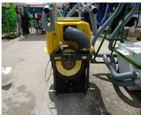
Foto 4. Espolvoreador con las partes móviles resguardadas
