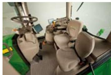
Vertrieb por su asiento con suspensión activa 'Active Seat II', que utiliza módulos eléctricos y electrónicos. La utilización de este sistema de gestión electrónica permite una respuesta mucho más rápida, en comparación con los sistemas hidráulicos.
