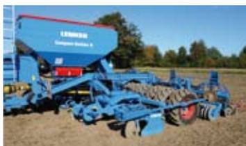
En este apartado Lemken GmbH & Co. KG ha recibido una Medalla de Plata por el 'Control de tracción (ASR) en los rodillos asentadores', que evita que se hundan en suelos arenosos, transfiriendo carga del rodillo al tractor mediante el enganche tripuntal, lo que ayuda a mejorar la eficiencia en tracción y mantiene uniforme la profundidad de trabajo.
