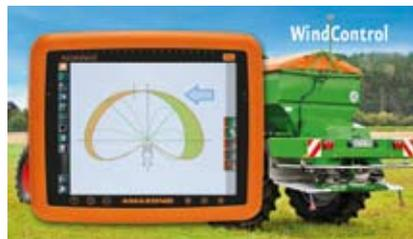
los datos que el proporciona una estación meteorológica, situada en la propia abonadora, que informa de la dirección del viento y su intensidad. El software toma en consideración las características físicas del abono utilizado.
