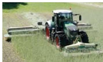
droneumático del mecanismo de siega con ajuste, asistido por ordenador, de la presión de apoyo en la superficie. El 'Constant-Float' regula automáticamente la presión de apoyo, no solo a través del acumulador hidráulico, sino de forma combinada con los sensores de ángulo situados en la barra de siega, lo
