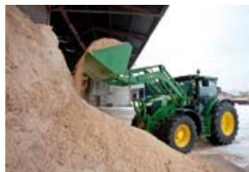
gador frontal H', que permite programar posiciones finales del brazo y de las herramientas del cargador, así como posiciones intermedias para todo el rango de elevación de las herramientas del cargador (guía paralela electrohidráulica). El ajuste se realiza en el terminal del tractor, con lo que tractor y cargador forman una unidad funcional.
