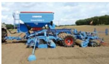
de Plata por su 'Regulación automática de las unidades de siembra', que garantiza la profundidad de siembra con independencia de las condiciones de resistencia del suelo y de la velocidad de avance. Utiliza doble disco y rodillo-guía de control centralizado, con un sensor de profundidad que registra los cambios de presión y proporciona valores de medición para el ajuste.
