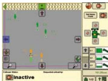
parcelas, sin que se produzcan paradas de las cosechadoras. El conductor del tractor ve en una pantalla la posición, la dirección y el grado de llenado de las tolvas de las cosechadoras, lo que le permite trasladar el tractor hasta la cosechadora que primero llenaría su tolva. De esta manera, se evitan tiempos muertos y desplazamientos innecesarios
