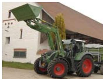
Así, se premia a AGCO GmbH Fendt, por su cargador frontal automatizado con báscula 'Fendt Cargo Profi', que dispone de sensores adicionales que permiten realizar nuevas tareas. Es posible preseleccionar dos posiciones finales máximas del brazo y del dispositivo de trabajo delantero que se alcanzan de manera automática, limitando así el rango del desplazamiento. Hay una función de amortiguación de la vibración condicionada por la velocidad y los controles se integran en el terminal del tractor.
