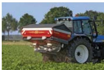
GMBH, por su sistema 'GEOspread', que junto con el GPS, ajusta la salida de abono en los cabeceros y extremos de parcelas, manteniendo constante la velocidad de giro de los discos. La gestión del sistema sigue el protocolo ISO-BUS
