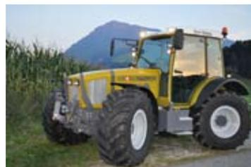
el pivotamiento del vehículo y trabajar de forma segura sobre pendientes, optimizando la tracción sobre los terrenos planos. Puede transferir hasta 80 kW de potencia eléctrica a otros aperos y máquinas externas. Con la información disponible no se puede profundizar en la descripción de este tractor, que posiblemente utilice un motor térmico con transmisión eléctrica hasta los motores situados en las ruedas.
