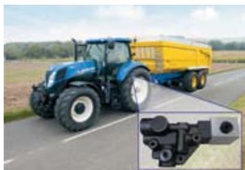
gracias a un frenado específico del remolque. Funciona sin dispositivos adicionales en el remolque, por lo que es compatible con todos los remolques con servofreno, incluyendo también la tecnología más moderna de frenos ABS.
