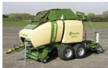
En el grupo de equipos de recolección han recibido Medallas de Plata la empresa Bernard Krone GmbH Maschinenfabrik por su 'Empacadora con unidad extensora del plástico de altura regulable automáticamente', en la que la altura de trabajo del dispositivo empacador que coloca el plástico se ajusta automáticamente al diámetro de la paca gracias a un sensor del ángulo de giro. De esta manera es posible hacer pacas con un diámetro de entre 1.00 y 1.75 m.
