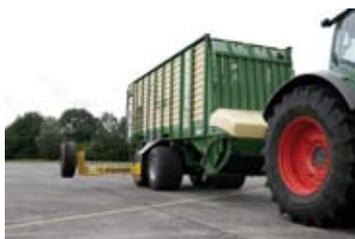
presa Ludwig Bergmann GmbH Maschinenfabrik, junto con la Escuela Técnica Superior de Osnabrück, por un chasis universal que integra en una construcción modular la estabilización activa de oscilación, la gestión de tracción, la compensación en pendientes, la regulación de nivel, el eje elevador y una báscula. La plataforma mecatrónica de transporte está configurada para todo tipo de equipos agrícola
