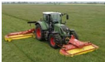
control de aperos y máquinas situadas en el enganche frontal del tractor, para lo que utiliza un sensor de posicionamiento que detecta los desniveles de manera inmediata y activa, ajustando automáticamente la presión de descarga. El dispositivo sigue dinámicamente el contorno variable del suelo con una presión de apoyo constante
