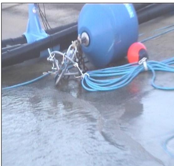
Figura 5. Boya y cable adujadas listas para salir. Como se puede ver se le colocó al cable una pequeña boya para evitar su hundimiento. Estos componentes conformarán posteriormente el entramado superficial. Para unirlos se colocaron un total de 28 grilletes.
