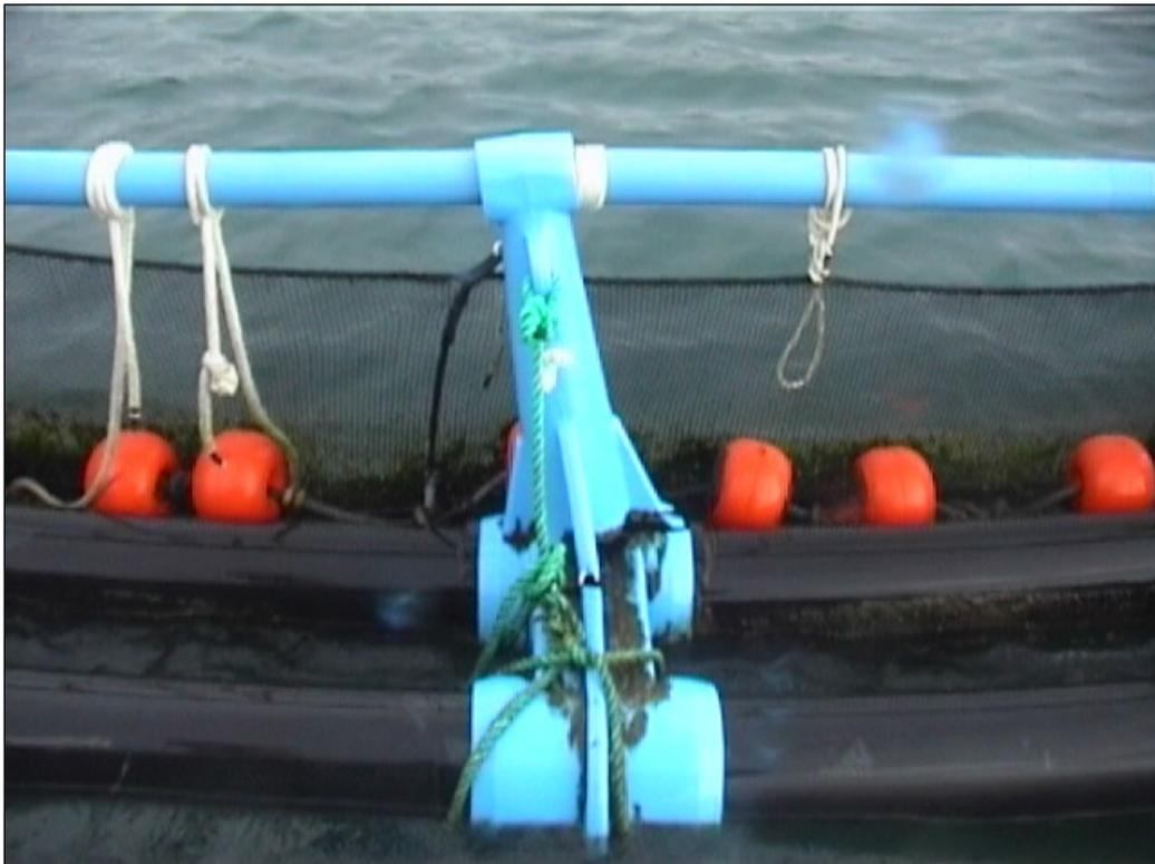
Figura 1. En ella podemos observar el soporte vertical de la barandilla roto en su base debido a un abatimiento lateral.
