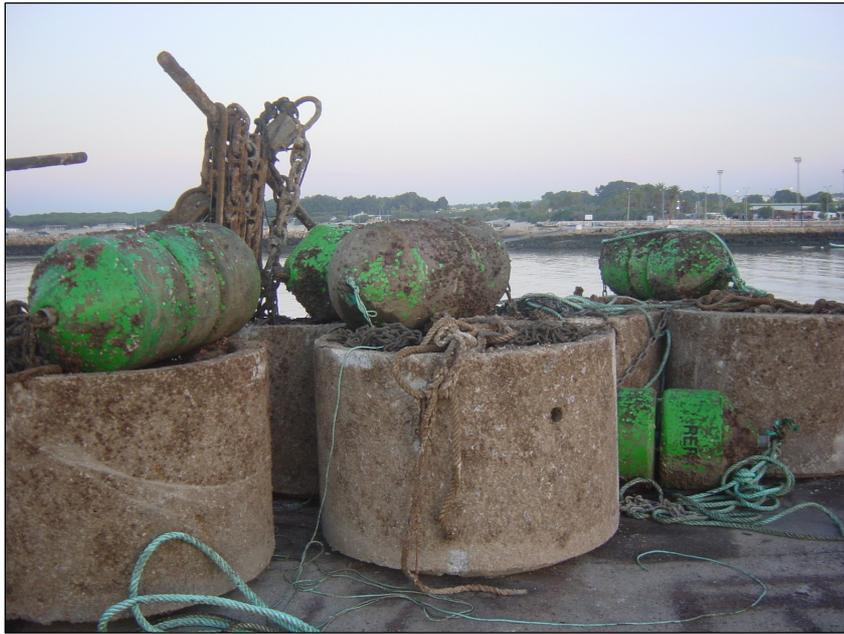
Figura 7. Pesos con cadena y boyas conectadas.
