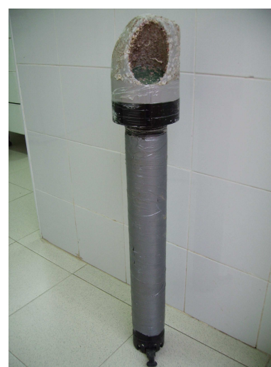
Fotografía 5.3 Correntímetro NORTEK Aquadopp. Fuente: E.P. DAP
