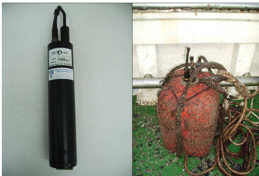
Fotografía 5.2 Fluorómetro WETLabs FLNTUSB y sistema de fondeo. Fuente: E.P. DAP
