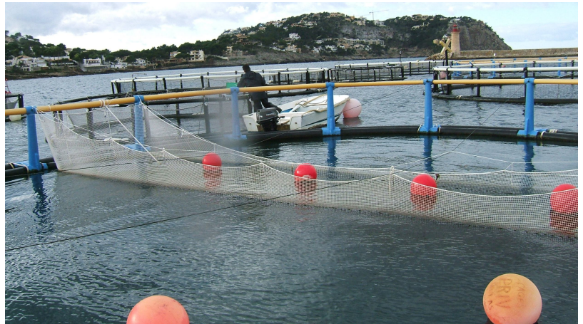
Fig 4 y 5: Diseño del tubo de engorde con soportes para red de protección. Pruebas de la red de protección en jaulas del puerto de Andratx.
