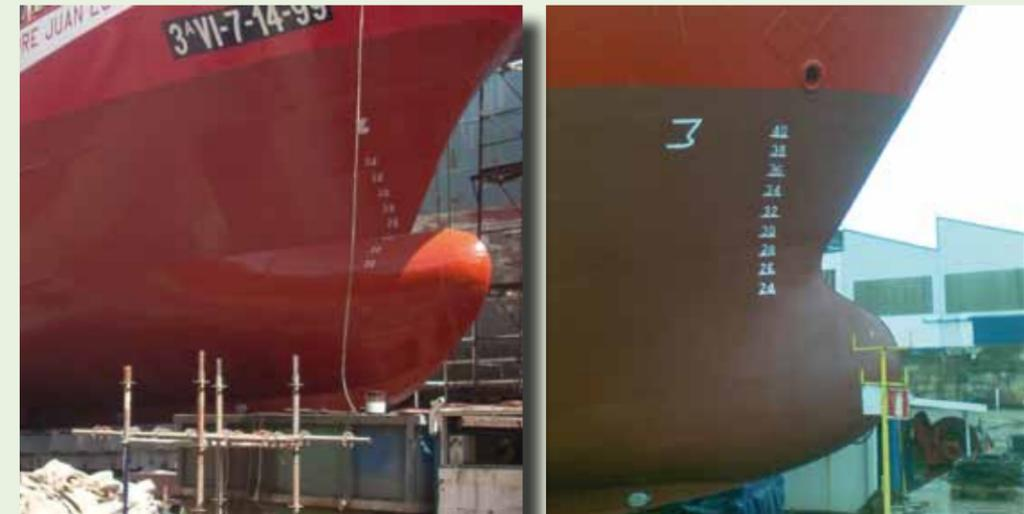
Fig. 51: Comparación de dos bulbos de proa.
