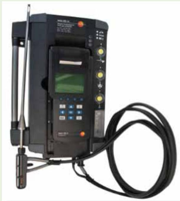
Fig. 97: Equipo de medición de gases de combustión.
