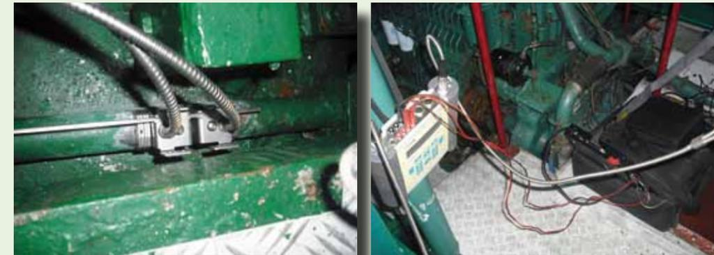
Fig. 101: Caudalímetro instalado en la línea de combustible de un motor principal.
