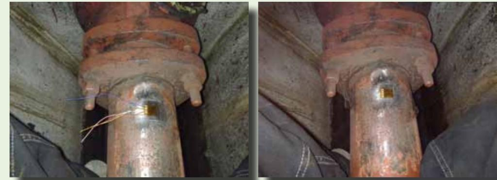
Fig. 98: Instalación y cableado de la galga extensiométrica.
