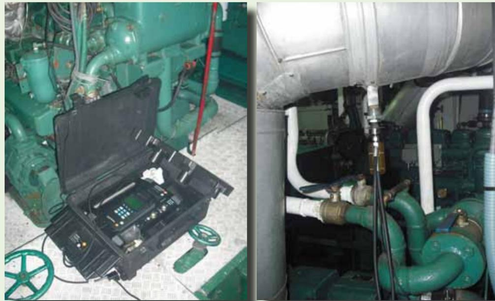
Fig. 100: Mediciones de gases de combustión.
