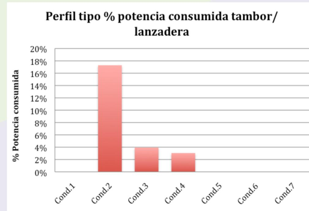
Fig. 146: Perfil tipo % potencia consumida por el tambor / lanzadera según condición de operación.
