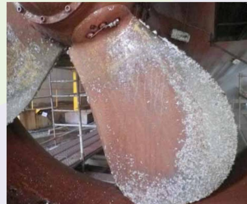
Fig. 162: Estado típico de la superficie de una hélice durante una varada.
