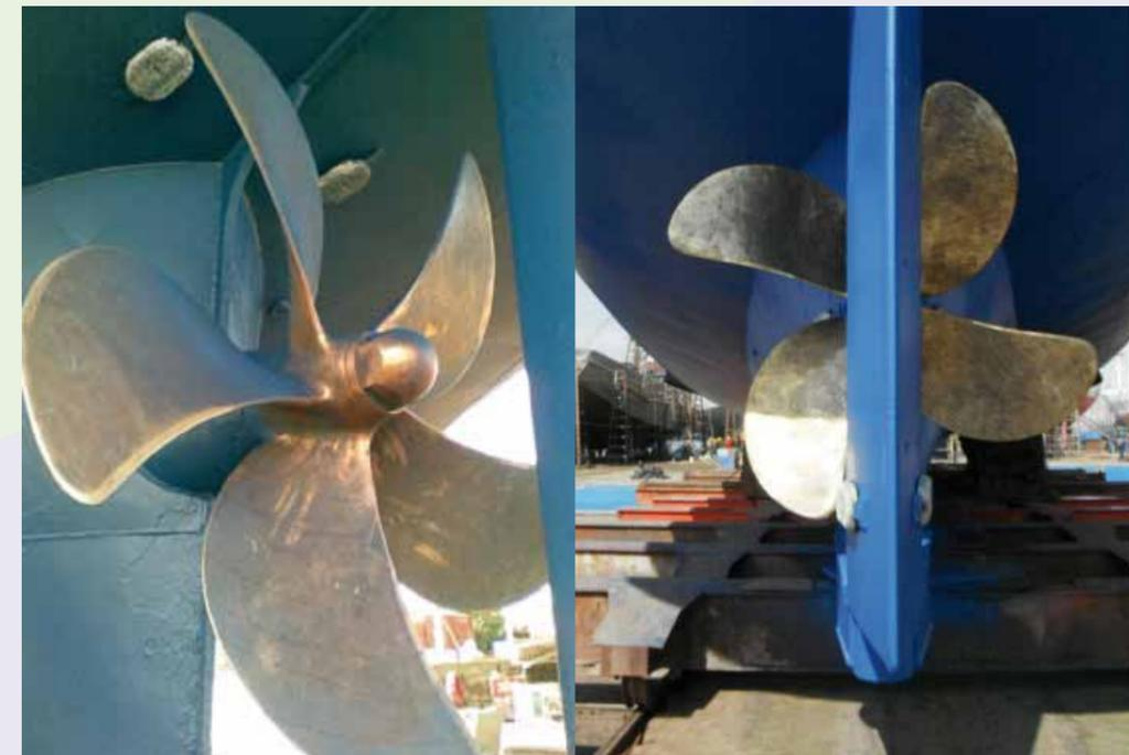
Fig. 70: Hélices de cuatro y cinco palas.
