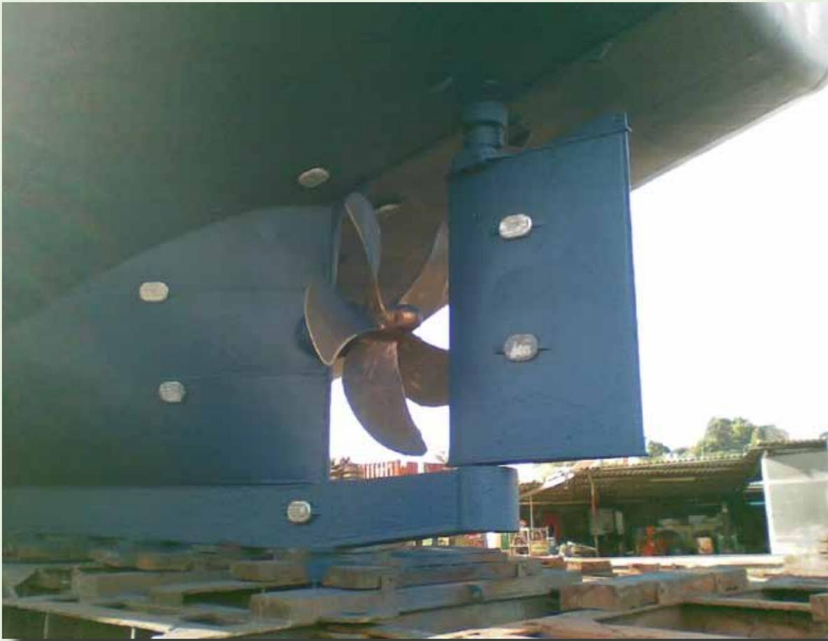
Fig.171 Anodos de sacrificio tradicionales instalados en la popa de un buque.
